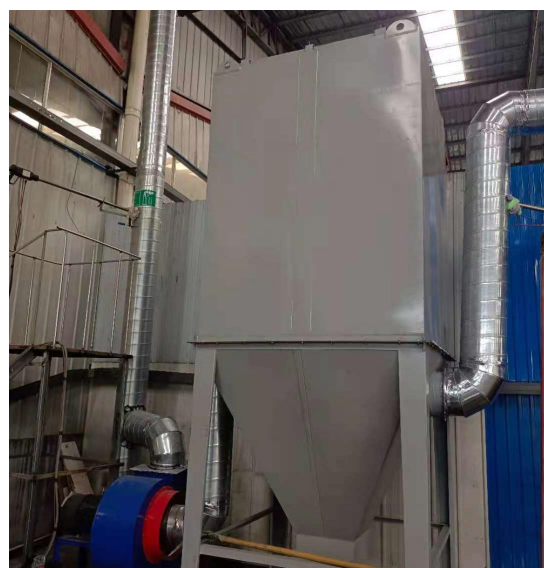
图 4-1 二次研磨、筛分工序布袋除尘器
