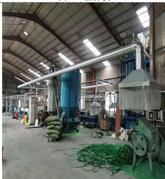
图 3-6 打包带生产线
