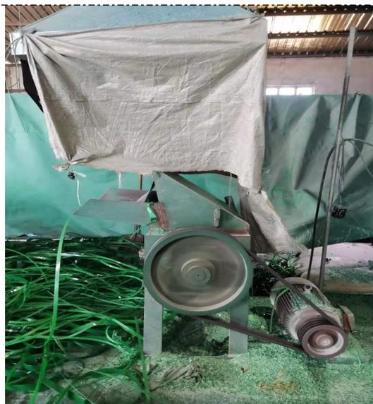
图 4-4 破碎机废气收集罩
