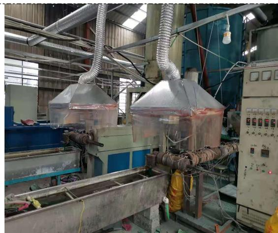
图 4-1 挤出废气集气罩
