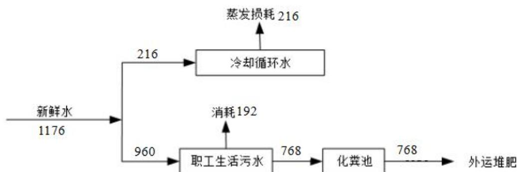
图 3-1 本项目水平衡图 (m<sup>3</sup>/a)
