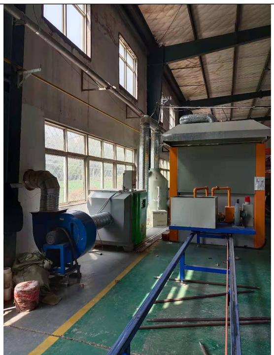
图 3-5 喷涂固化生产线
