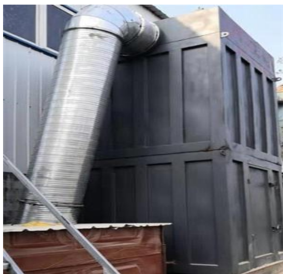
图 4-1 脉冲布袋除尘器
